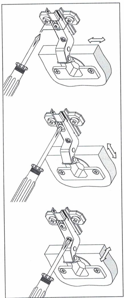
**Регулирование по высоте      Регулирование глубины      Регулирование напложения**
